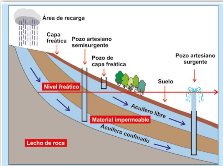
Esquema de los diferentes acuíferos
